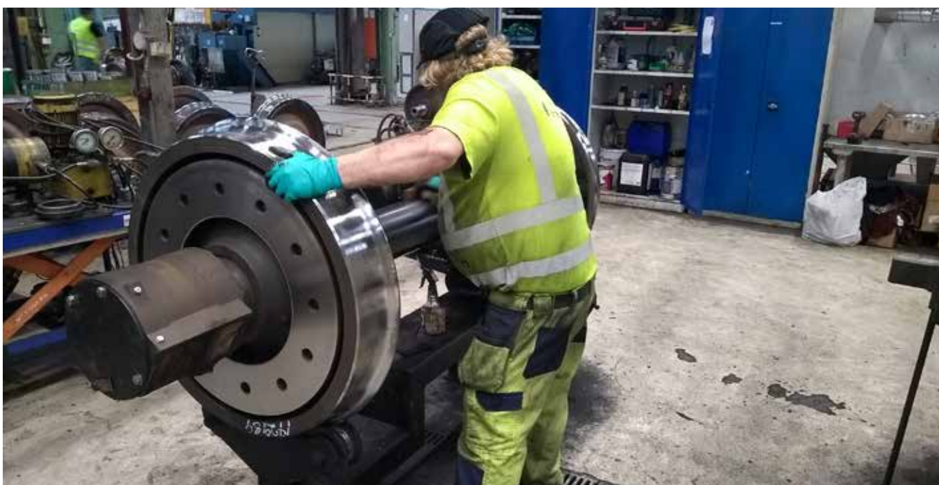
Puss og smøring av aksling
