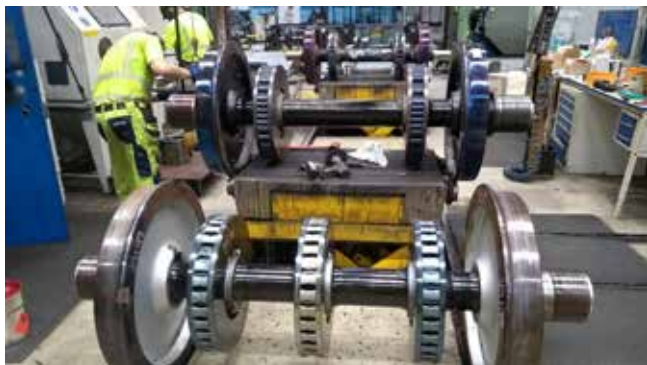
Akslinger med hhv. 3 og 2 bremseskiver
